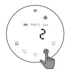
**自動模式(④)**:在自動模式中,雙重感應器會即時感測空氣質素,本產品會根據空氣質素環境自動調整風扇速度。控制面板會根據環境光線自動調整螢幕亮度。
