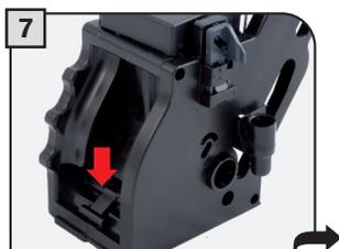
7 Le levier placé sur la partie arrière du groupe doit être en contact avec la base.
