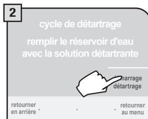
Lorsque la machine s'arrête, l'écran affiche le message suivant : « remplir le réservoir d'eau avec la solution détartrante ». Procédez au détartrage de l'appareil en appuyant sur « démarrage détartrage » comme décrit précédemment.
