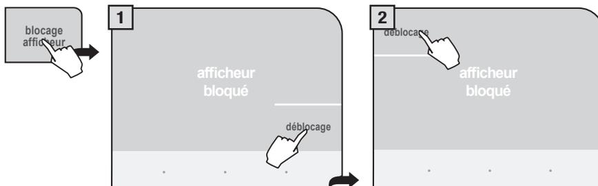
Pour réactiver l'afficheur, appuyez sur « déblocage » en bas à droite, ensuite (dans les deux secondes qui suivent) sur « déblocage » en haut à gauche (cette touche n'apparaît que lorsque vous avez appuyé sur la première touche de déverrouillage).
