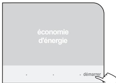
Pour démarrer la machine, appuyez sur « démarrer ». La machine procède au diagnostic des fonctions. Après la phase de chauffage, elle est prête à fonctionner.
