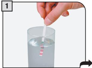
Plongez dans l'eau la bande de test fournie avec le kit pendant une seconde, afin de vérifier la dureté de votre eau.
