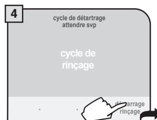
Effectuez le rinçage des circuits de la machine en appuyant sur « démarrage rinçage ».
