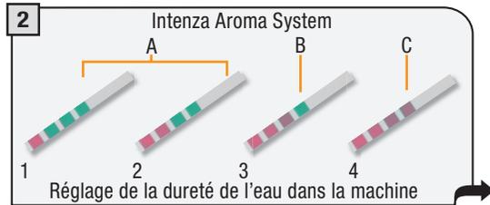
Contrôler la valeur de dureté de l'eau dans la bande de test.
