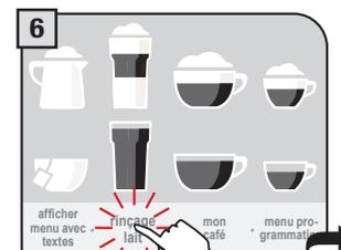
L'appareil propose de nettoyer les circuits lait. La touche clignote. Appuyez sur « rincer lait » pour effectuer le nettoyage des circuits internes.
