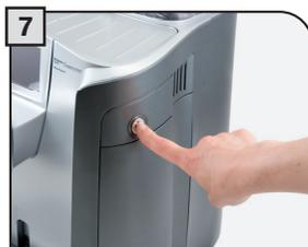
Appuyez une fois sur l'interrupteur général pour allumer la machine. L'appareil procède lui-même à un diagnostic des fonctions. Ce test est effectué chaque fois que l'appareil est allumé.
