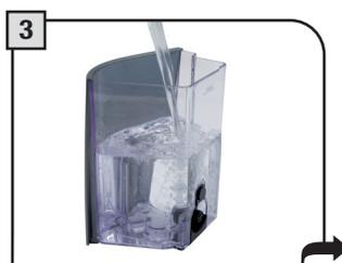
Retirez le réservoir à eau et rincez-le avec de l'eau potable fraîche afin d'éliminer les traces éventuelles laissées par le produit détartrant. Ensuite, remplissez le réservoir avec de l'eau potable fraîche et remettez-le en place.
