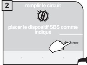
Appuyez une fois sur l'écran tactile ; la machine démarre le cycle d'amorçage du circuit hydraulique.
