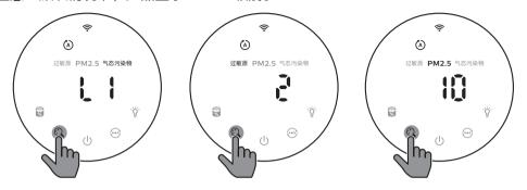
• 轻触 Q 按钮可在 PM2.5/气态污染物/过敏原之间切换显示指示灯。
