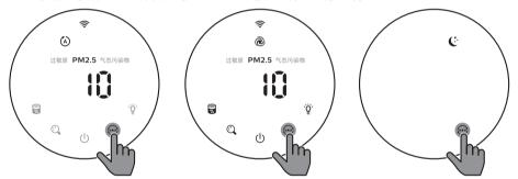
**自动模式((A))**: 在自动模式下,双传感器实时感应空气质量,设备会根据环境 空气质量自动调整风扇速度。
