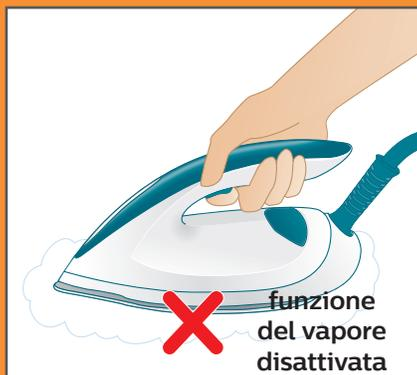
La funzione del vapore verrà automaticamente disattivata se la rimozione del calcare non viene effettuata.
