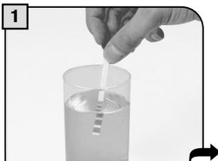
Den Teststreifen für die Wasserhärte für einen Zeitraum von 1 Sekunde in das im Wassertank befindliche ungefilterte Frischwasser eintauchen.
