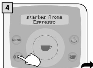
Soweit dies gewünscht wird, wird die zu mahlende Kaffeemenge durch ein- oder mehrmaligen Druck der Taste **000** angewählt.
