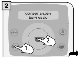
Die Funktion durch Drücken der Taste **000** auswählen, bis die Option gemahlener Kaffee angezeigt wird. Zur Bestätigung die Taste
