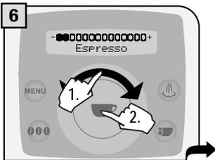
Die Tassenfüllmenge durch Bewegung des Fingers über den Anwahrling ändern und mit der Taste
