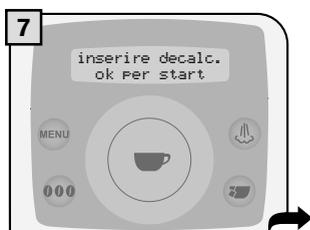
Quando appare il seguente messaggio la caldaia è alla giusta temperatura
