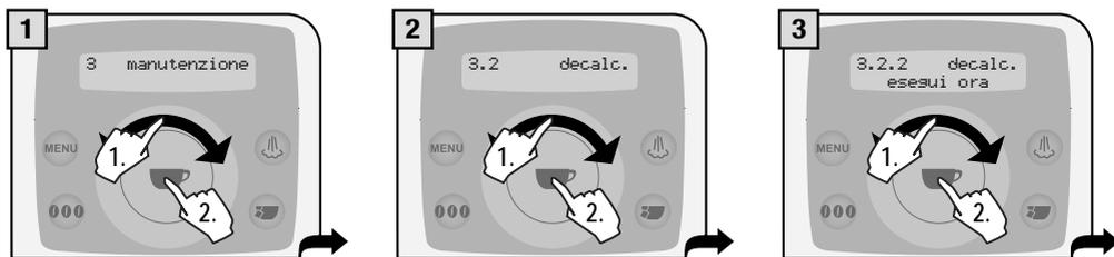
La decalcificazione viene eseguita ad una temperatura controllata. Se la macchina è fredda, si deve attendere il raggiungimento della giusta temperatura; in caso contrario, si deve eseguire il raffreddamento della caldaia nel modo seguente:
