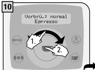
Den Wert der Vorbrührung (normal, stark, aus) durch Bewegung des Fingers auf dem Anwahrling einstellen. Für die Speicherung die Taste
