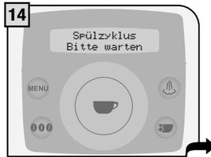
Die Maschine führt die Spülung durch. Während des Spülzyklus kann die Maschine dazu auffordern, den Wassertank zu füllen. In dem Fall den Wassertank entnehmen und befüllen.
