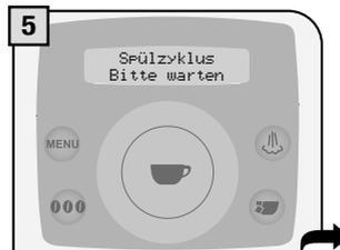
Nach Abschluss der Aufheizphase wird eine kleine Wassermenge ausgegeben. Warten Sie, bis dieser Zyklus automatisch beendet wird. Für die Ein-/Ausschaltung dieser Funktion siehe Seite 19.
