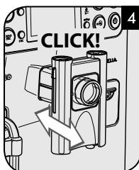
**RO** Verificați ca distribuitorul să se afle în poziție corectă.
