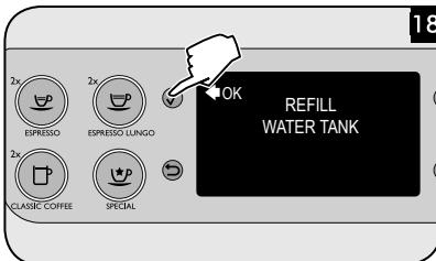
**RO** Așezați la loc rezervorul de apă. Apăsați tasta ✓.
