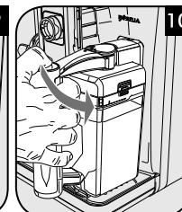
**SR** Zatvorite blok za ispuštanje posude za mleko okrećući ga u smeru suprotnom od kretanja kazaljki na satu.
