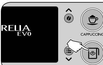
**Натиснете бутона . Машината извършва допълнителен цикъл на почистване.**
