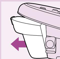
**1** Controllate di aver staccato la spina dalla presa di corrente da almeno 2 ore e che il serbatoio non sia caldo.
