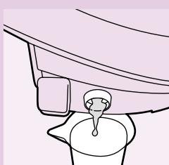
**5** Svuotate il serbatoio del vapore versando l'acqua in un recipiente o direttamente nel lavandino.
