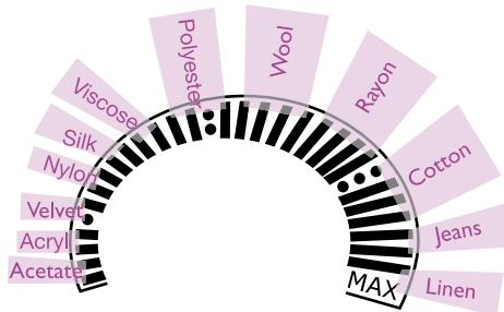
► La pantalla indica que la plancha se está calentando o enfriando para alcanzar la temperatura seleccionada.
