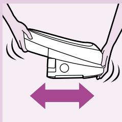
**4** Incline o depósito de vapor para o lado e retire-lhe a tampa e a ligação de enxaguamento "calc-clean" com a chave especial fornecida ou com uma moeda.
