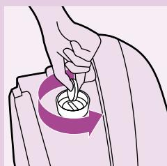
**4** Retirez le capot du système auto-nettoyage et le bouchon avec la clé spéciale ou avec une pièce de monnaie.
