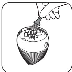
**10** Oczysć szczoteczką całe urządzenie, aby usunąć wszelkie pozostałości włosa.
