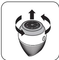
7 取下保护罩，逆时针旋转，旋开并摘下盖子。
