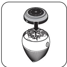
**12** Helyezze vissza és csavarozza vissza a fedelet a készülékre.
