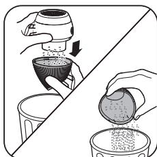
6 將產品倒放，輕輕拉開並將絨毛清空至護蓋中。將絨毛收集至護蓋中，即可將其倒入垃圾桶內。
