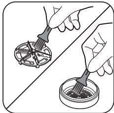
**9** Verwenden Sie die mitgelieferte Bürste, um die Klingen und den inneren Deckel zu reinigen, um jegliche Fusselreste zu entfernen.
