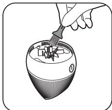
**10** Wischen Sie auch das Gerät mit der Bürste aus, um alle Fusselreste zu entfernen.
