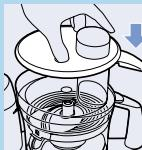
**► Příslušenství (emulgační kotouč, nože, hnětací příslušenství, držák vložek) vložte do držáku nástrojů a uložte do nádoby. Držák vložek vkládejte až nakonec.**
