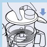
► Stavite pribor (disk za emulziju, nož, dodatak za miješenje, držač umetaka) na držač pribora i spremite u posudu. Držač umetaka uvijek stavite posljednji.
