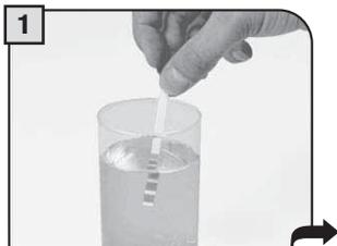
1 Plonger dans l'eau la bande de test fournie avec le kit pendant une seconde, afin de vérifier la dureté de l'eau.
