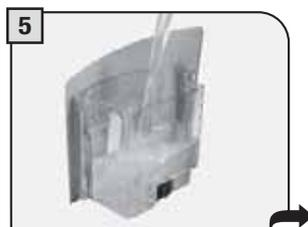
Verser la solution détartrante dans le réservoir. Remettre ce dernier dans la machine.
