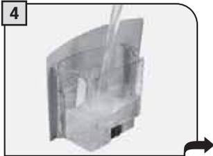
Remplir le réservoir avec de l'eau fraîche et potable, en veillant à ne jamais dépasser le niveau maximal marqué sur le réservoir. Replacer ensuite le réservoir.
