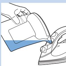
**Poznámka:** Pokud používáte vodu filtrovanou pomocí filtru pro odstranění vodního kamene IronCare, můžete nádržku na vodu naplnit přímo z tohoto filtru.
