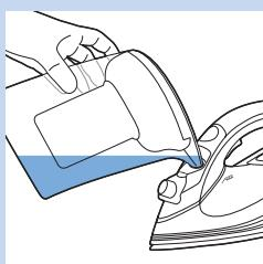
Napomena: Ako koristite IronCare filter za uklanjanje kamenca, možete da napunite rezervoar za vodu filtriranom vodom direktno iz filtera.
