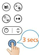
**22** Para desligar o aparelho, prima continuamente o botão de alimentação durante três segundos.
