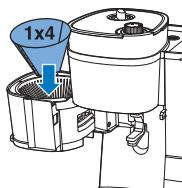
**5** Plaats een papieren filter (type 1x4 of nr. 4) in de filtermand en sluit de filtermandhouder.
