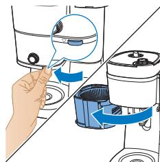
5 Placer et papirfilter (type 1x4 eller nr. 4) i filterkurven, og luk holderen til filterkurven.
