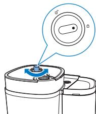
8 Drehen Sie den Regler zur Behälterverriegelung, um die Position zu sperren.
