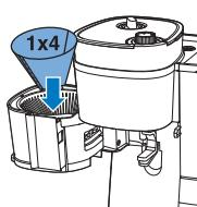
11 Вставте паперовий фільтр (типу 1x4 або №4) у кошик фільтра.
