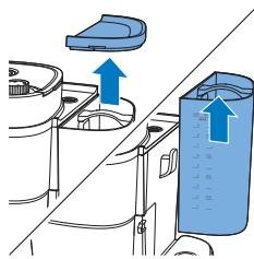
**1** Öppna vattenbehållarens lock och lyft ut behållaren ur apparaten.
