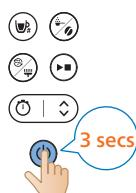
**22** Za izklop aparata za tri sekunde pridržite gumb za vklop/izklop.
