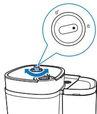
8 Поверніть регулятор блокування ємності в положення блокування.
