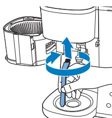
**7** Χρησιμοποιήστε το βουρτσάκι για να αφαιρέσετε τυχόν αλεσμένο καφέ ή υπολείμματα καφέ που μπορεί να έχουν συσσωρευτεί στην υποδοχή.
