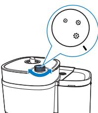
**10** Ta tag i fliken för att öppna filterhållaren.
