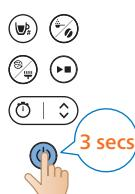
**15** Chcete-li přístroj vypnout, stiskněte a podržte tlačítko spuštění po dobu tří sekund.
