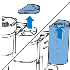
**1** Abra la tapa del depósito de agua y extráigalo del aparato.
