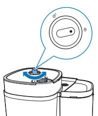
**8** Завъртете бутона за заключване на контейнера в заключено положение.
