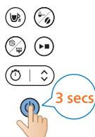
**22** Chcete-li přístroj vypnout, stiskněte a podržte tlačítko spuštění po dobu tří sekund.
