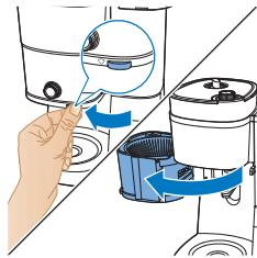
**5** Aseta suodatinpaperi (kokoa 1x4 tai nro 4) suodatinkoriin ja sulje suodatinkorin teline.
