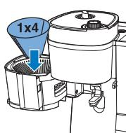
11 Setzen Sie eine Papierfiltertüte (Typ 1x4 bzw. Nr. 4) in den Filterkorb ein.
