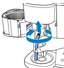
**7** Verwenden Sie eine Bürste, um Kaffeesatz oder Rückstände zu entfernen, die sich möglicherweise in der Schütte angesammelt haben.
