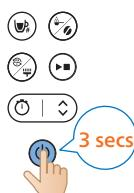
**22** Hold tænd/sluk-knappen nede i tre sekunder for at slukke apparatet.
