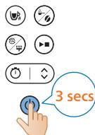
**22** Schakel het apparaat uit door de aan-uitknop drie seconden ingedrukt te houden.
