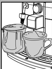
6 Inserire un contenitore vuoto sotto al tubo vapore ed uno sotto all'erogatore.
