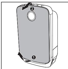
2 กดคลิปทึบสองลง และดึงแผ่นกรองเข้าหากัน เพื่อถอดแผ่นกรองขึ้นแรกออก
