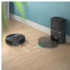
Ketika daya baterai rendah (<20%) saat membersihkan, robot secara otomatis kembali ke stasiun untuk mengisi ulang. Setelah daya baterai terisi, robot melanjutkan dari posisi yang ditinggalkannya.
