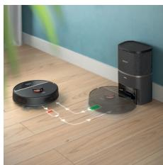
如果清洁时电池电量不足 (<20%), 扫拖机器人会自动返回到基座进行充电。电池充满电后, 扫拖机器人会继续之前暂停的操作。
