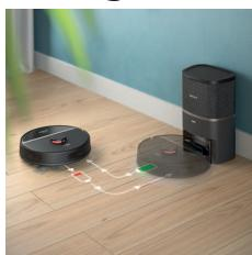
Cuando la batería se agote (<20%) durante la limpieza, el robot regresará automáticamente a la estación para volver a cargarse. Una vez cargada la batería, el robot continúa desde donde dejó.
