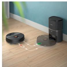
Apabila kuasa bateri berkurangan (<20%) semasa pembersihan, robot secara automatik kembali ke stesen untuk mengecas semula. Selepas bateri telah dicas, robot meneruskan pembersihan dari tempat terakhir yang ditinggalkannya.
