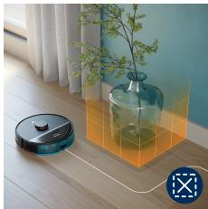
**i** Примечание. Робот-пылесос может застрять на коврах с высоким ворсом, коврах с бахромой или очень светлых ковриках, например в ванной комнате. Также робот-пылесос не может обнаруживать кабели на полу.
