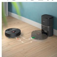
청소 중에 배터리가 얼마 남지 않으면(<20%) 로봇 청소기는 재충전을 위해 자동으로 스테이션으로 돌아갑니다. 배터리 충전이 완료되면 중단했던 곳으로 돌아가 다시 청소를 시작합니다.
