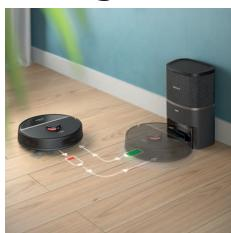
Quando o nível da bateria fica baixo (<20%) durante uma limpeza, o robô volta automaticamente à base para recarregar. Depois de carregar a bateria, o robô continua de onde parou.
