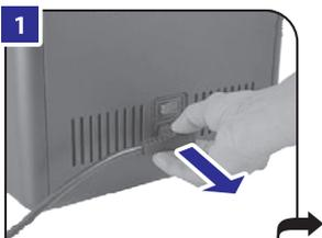
Išjunkite aparatą ir atjunkite jį nuo elektros tinklo.
