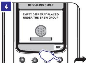
Ištuštinkite lašėjimo padėkliuką, esantį po ištekėjimo latakų (39 puslapyje 2 paveikslėlis) ir įdėkite jį atgal į aparatą. Tuomet spauskite "OK" mygtuką.
