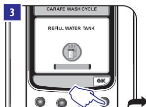
Užpildykite talpą šviežiu geriamuoju vandeniu iki MAX žymos. Patvirtinkite spausdami "OK".
