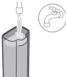
**10** Wyjmij zbiornik wody i wypłucz go pod kranem. Napełnij zbiornik zimną wodą z kranu i włóż go z powrotem do urządzenia.
