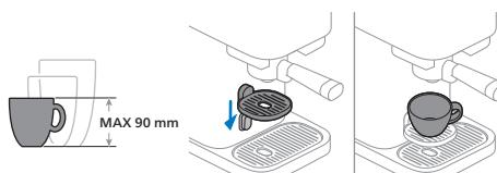
Plaats een kleinere kop (met een hoogte tot 90 mm) op het kopjesplateau.
