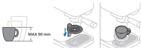
小杯子（高度不超过 90 毫米）可直接放置在杯台上。
