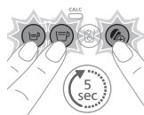
Maintenez les boutons Espresso, Lungo et Booster d'intensité enfoncés simultanément pendant 5 secondes, jusqu'à ce que tous les voyants commencent à clignoter rapidement, indiquant que les paramètres d'usine de la machine ont été rétablis.
