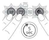
Houd de knoppen voor espresso, lungo en extra sterke koffie tegelijkertijd 5 seconden ingedrukt, totdat alle leds snel beginnen te knipperen om aan te geven dat de instellingen in het apparaat zijn teruggezet naar de fabrieksinstellingen.
