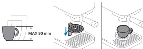
Placez une petite tasse (d'une hauteur maximale de 90 mm) sur le support pour tasse.
