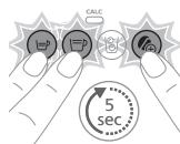
Naciśnij i przytrzymaj jednocześnie przyciski Espresso, Lungo i zwiększenia intensywności przez 5 sekund, aż wszystkie diody LED zaczną szybko migać, aby pokazać, że urządzenie zostało zresetowane do ustawień fabrycznych.
