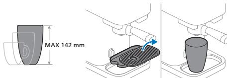
Zdejmij pokrywę tacki ociekowej i samą taczkę ociekową, aby uzyskać dodatkowe miejsce na umieszczenie wyższej filiżanki lub szklanki o wysokości do 142 mm.
