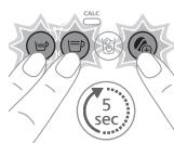
Halte die Tasten für Espresso, Café Crema und Intensitätsverstärkung gleichzeitig 5 Sekunden lang gedrückt, bis alle LEDs schnell blinken, um anzusehen, dass die Maschine auf die Werkseinstellungen zurückgesetzt wurde.
