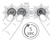
Tenete premuti contemporaneamente i pulsanti Espresso, Lungo e il pulsante di aumento dell'intensità per 5 secondi, finché tutti i LED non iniziano a lampeggiare velocemente a indicare che sono state ripristinate le impostazioni di fabbrica della macchina.
