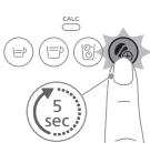
**6** Aby opłukać ekspres, naciśnij i przytrzymaj przycisk zwiększenia intensywności przez 5 sekund, aż dioda LED zacznie powoli migać.
