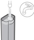
**10** Verwijder het waterreservoir en spoel het af onder de kraan. Vul het waterreservoir met koud kraanwater en plaats het terug in het apparaat.
