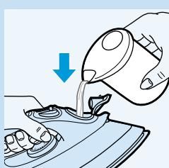
Pokud je voda ve vaší oblasti nadměrně tvrdá, doporučujeme vám míchat ji s destilovanou vodou nebo používat pouze destilovanou vodu. Nepoužívejte ocet, škrob nebo chemicky odvápňovanou vodu.
