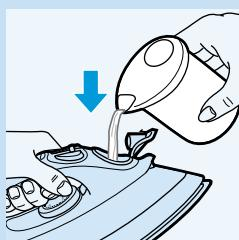
**5 Turnați apă de la robinet din recipientul de umplere în rezervor până la gradația maximă.**
