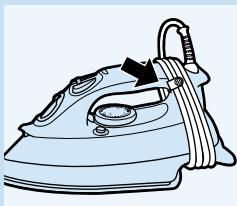
a) Ostavite glaćalo da se ohladi. Omotajte mrežni kabel oko spremnika i učvrstite hvataljkom. Model GC4040 isporučuje se s kabelom dugim 3m.
