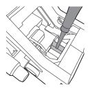
3 Нанесите смазку тонким слоем на поверхность вала в нижней части варочной группы.
