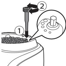
**警告：** 轉動研磨粗細調整旋鈕時，每次請勿超過一個溝槽，以免研磨機受損。
