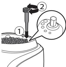
**警告：**为防止损坏研磨机，请勿将研磨度调整旋钮一次转动多档。
