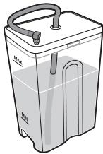
**11 将牛奶接头插入储奶容器盖上的管脚，并将储奶容器放入冰箱中。**
