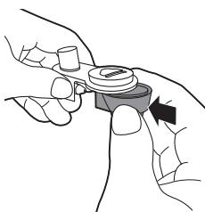
8 將自動奶泡機安裝至奶泡機上蓋。聽到喀噠聲，表示兩個零件安裝到位。
