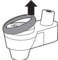
4 拆除自動奶泡機時，請按住側邊 (1) 稍微左右移動拉出 (2)。
