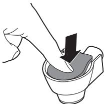
8 将自动奶泡器安装到奶泡器盖上。当两个部件锁定到位时，您会听到喀哒声。
