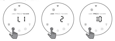
• 轻触 Q 按钮可在 PM2.5/气态污染物读数/过敏原之间切换显示指示灯。
