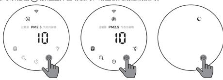
**自动模式(⑥)**:在自动模式下,双传感器实时感应空气质量,设备会根据环境空气质量自动调整风扇速度。
