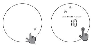
借助光感应器,控制面板可根据环境光线自动打开、关闭或变暗。在环境光线较暗时,控制面板的亮度也将变暗或关闭。此时轻触控制面板的按键区,可以唤醒控制面板查看空气情况。如果没有进一步操作,指示灯和控制面板将再次变暗,继续保持与环境光线相匹配。
